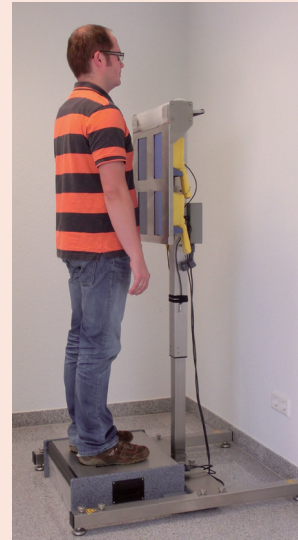
Bild 3: ECMo - stationärer Einsatz von Kontaminationsmonitoren. (Bilder: S.E.A. GmbH)
