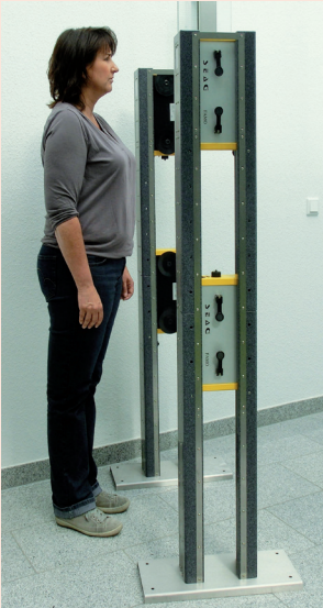
Bild 1: FAMO-Portalmonitor, Messung der Gamma-Kontamination beim Durchgang.
