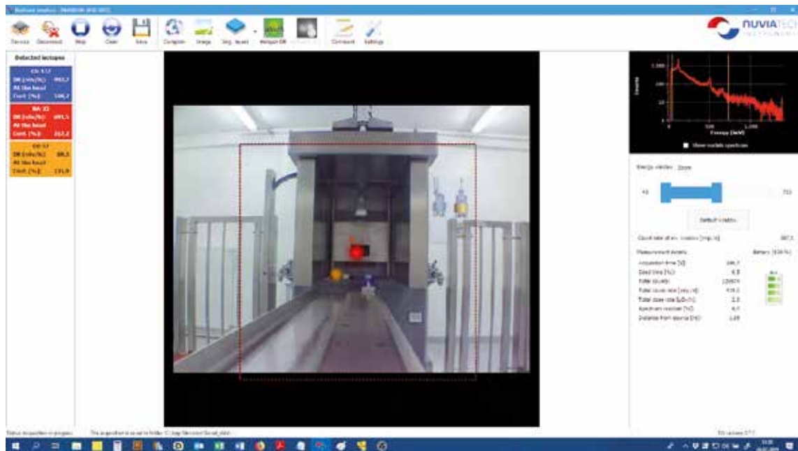
Ein Bild sagt mehr als tausend Worte: In der Mitte sieht der Anwender das Messobjekt in Echtzeit. Die verschiedenen Nuklide (hier Cs-137, Na-22 und Co-57) werden farblich gekennzeichnet und auf der linken Seite beschrieben. Das Gesamtenergiespektrum wird auf der rechten Seite dargestellt.
