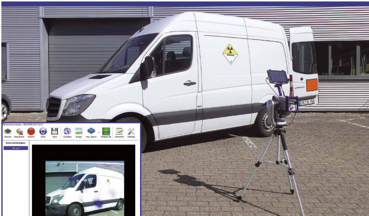
Auch wenn eine nuklididentifizierende Gamma-Kamera nicht mehr viel mit dem Geiger-Zähler verbindet, bleibt eine Gemeinsamkeit: Beide sind auch von Nutzern mit wenig Erfahrung zu bedienen.
