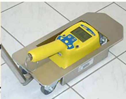
CoMo-170 mit Fußbodenkontrollvorrichtung
